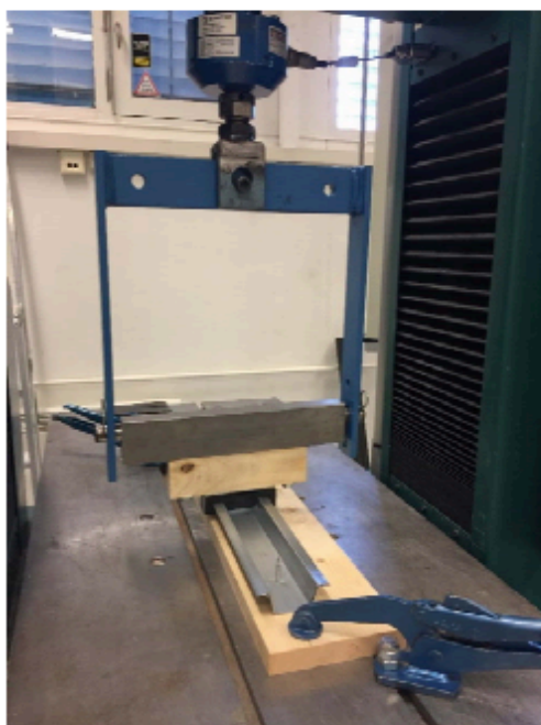
Figur 3. Prøvingsoppsett for takmontering (uttrekk).
