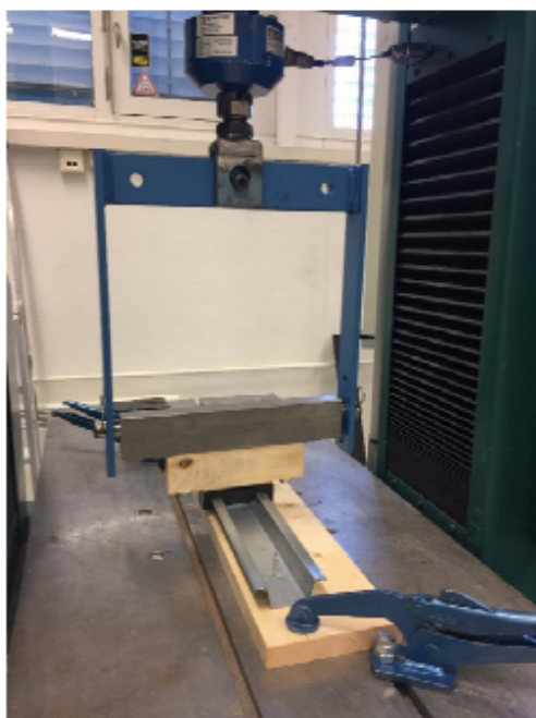
Figur 3. Prøvingsoppsett for takmontering (uttrekk).
